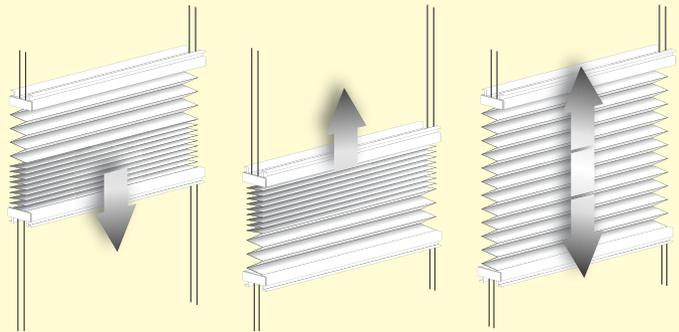
Durch stufenloses Verschieben der Ober- und Unterschiene erhalten Sie immer den perfekt eingestellten Sonnenschutz.
