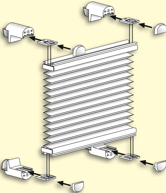
Das Plissee lässt sich in jeder gewünschten Position fixieren. Die Bedienung erfolgt über die Griffe an der Ober- und Unterschiene. Durch die seitliche Verspannung erhält das Plissee einen hohen Bedienkomfort und stellt sicher, dass die Bedienschiene zuverlässig in jeder gewünschten Position verbleibt.
